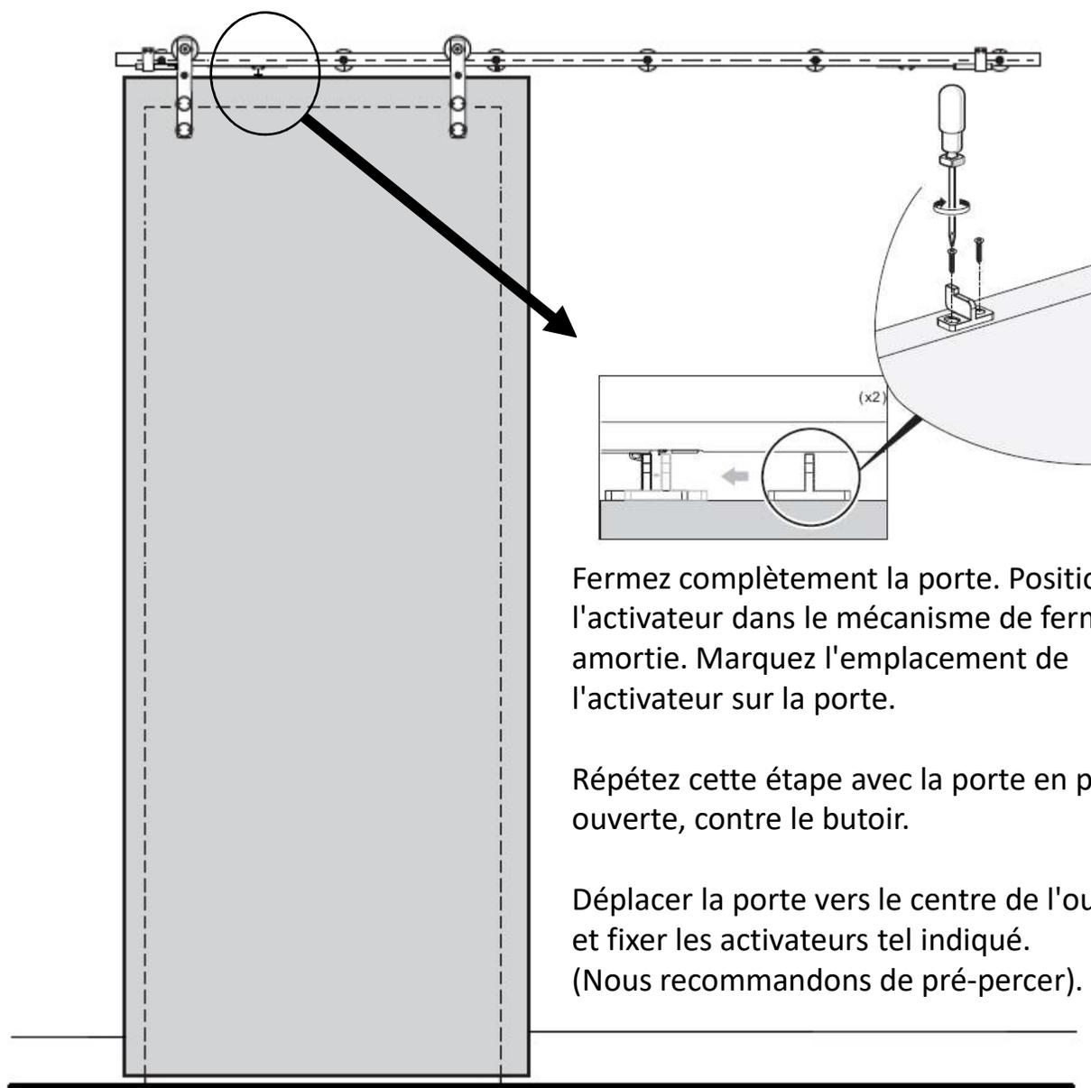
Fermez complètement la porte. Positionnez l'activateur dans le mécanisme de fermeture amortie. Marquez l'emplacement de l'activateur sur la porte.
