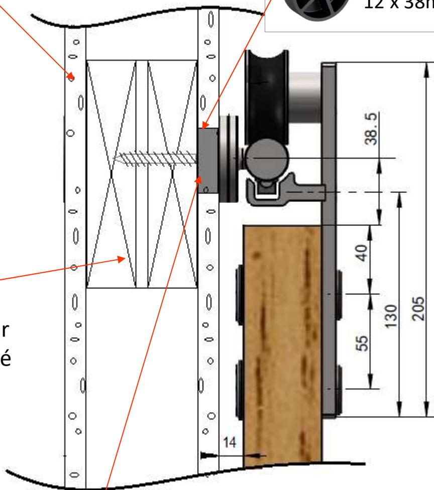
Percer un trou de 38 mm (1-1 / 2 po) dans un panneau de cloisons sèches et insérez le (s) disque (s) à l'épaisseur appropriée
