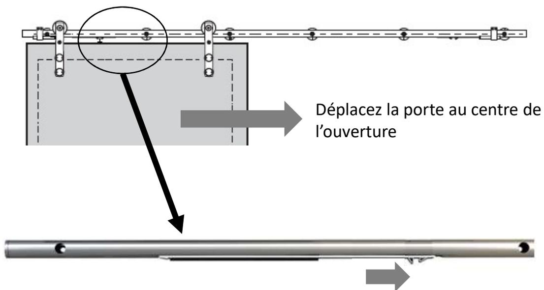
Chargez le mécanisme de fermeture amortie en poussant manuellement les languettes vers le centre de l'ouverture jusqu'à ce qu'elles s'arrêtent (vous sentirez une résistance).
