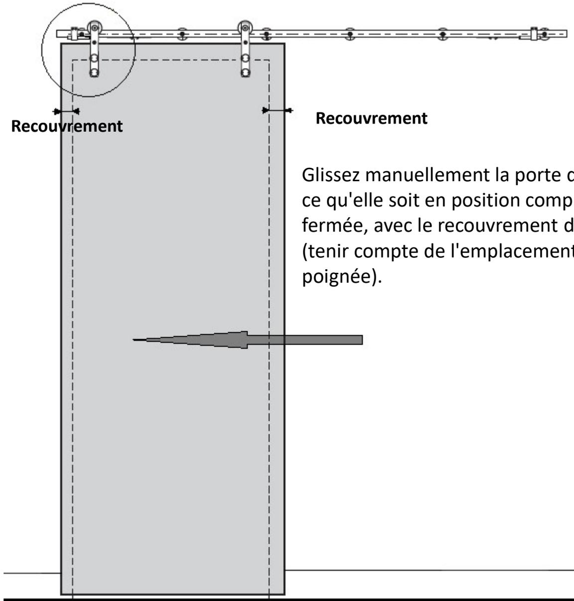
Glissez manuellement la porte de façon à ce qu'elle soit en position complètement fermée, avec le recouvrement désiré (tenir compte de l'emplacement de la poignée).
