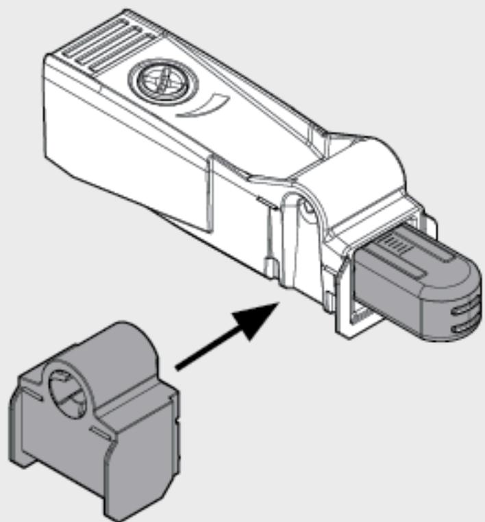
L'espaceur en semi-applique s'intègre au côté du dispositif Blumotion pour un montage rapide et facile.
