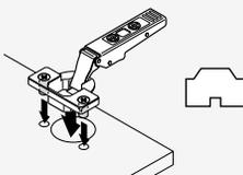
Gougeons prémontés, s'installent avec la MINI PRESSE Blum
