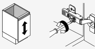
Pour une plaque sans came, dévisser la vis, ajuster la porte et resserrer la vis.
