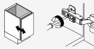
Pour CLIP, dévisser la vis arrière, ajuster la porte et resserrer.
