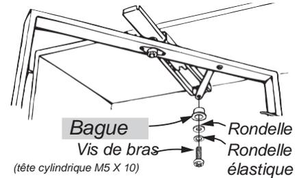
**ATTENTION** Ne montez pas la bague dans la mauvaise direction.
