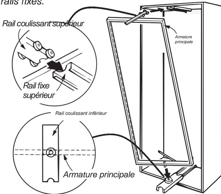
Alignez l'armature avec la rainure du rail couissant inférieur dans la bonne direction.
