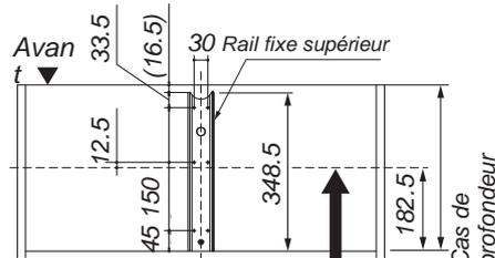
Un mauvais alignement de la position de la ligne centrale du rail fixe inférieur / supérieur devrait être de moins  $\pm 1\text{mm}$
