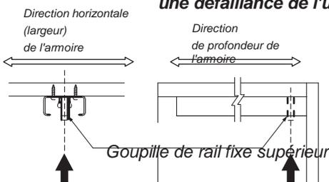
Le mauvais alignement des goupilles inférieures et supérieures devrait être de moins de  $\pm 1\text{mm}$  à l'horizontale / verticale.
