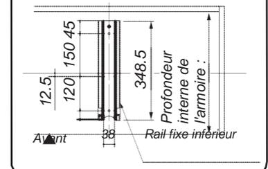
\* Il faut que l'inclinaison horizontale ou verticale de l'armoire soit de moins d'1mm.
