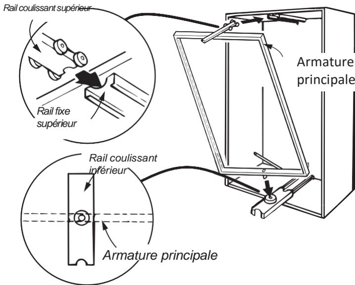
Alignez l'armature avec la rainure du rail couissant inférieur dans la bonne direction.
