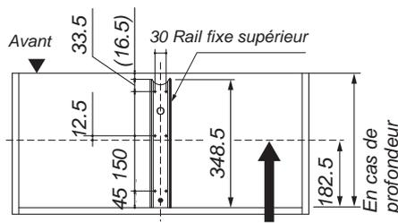
Un mauvais alignement de la position de la ligne centrale du rail fixe inférieur / supérieur devrait être de moins  $\pm 1$ mm
