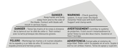
**DANGER** Tenez les mains et le corps à distance de la lame et sur le côté de celle-ci. Tout contact avec la lame provoque des blessures graves.
