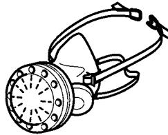
Le risque d'exposition à de tels produits varie selon la fréquence à laquelle vous faites ce genre de travail. Pour réduire les risques d'exposition à ces substances chimiques : travaillez dans un endroit adéquatement ventilé et utilisez un équipement de sécurité approuvé, tel que masques antipoussières spécialement conçus pour filtrer les particules microscopiques.
