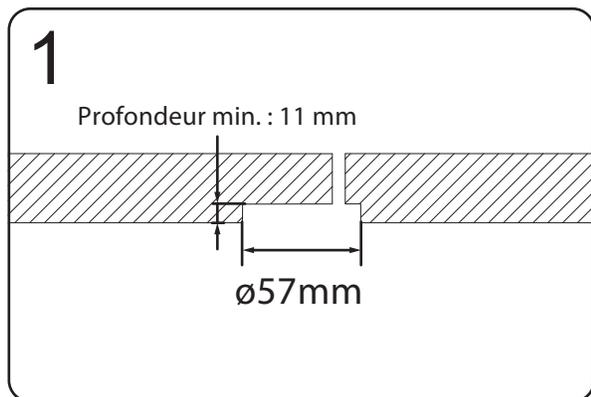
Percer un trou de 57 mm de diamètre.
