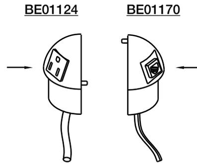
Assemblez les deux moitiés et insérez-les dans le trou de 3 pouces.
