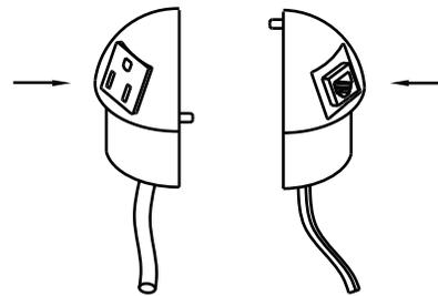
Assemblez les deux moitiés et déposez-les dans le trou de 3 po.
