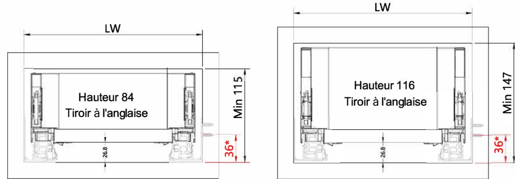
\* Min. 36mm pour les tiroirs avec panneau avant d'aluminium vs. 32mm pour les tiroirs standard
