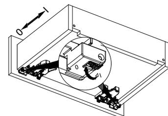
Réglage de la profondeur 0~+3mm.
