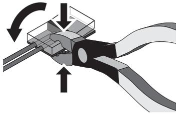
7. Soulevez doucement le couvercle du connecteur pour pouvoir insérer le ruban DEL au-dessus de la broche de connexion à l'intérieur du connecteur. Alignez soigneusement le ruban de façon à ce que le couvercle supérieur du connecteur KLIPR se ferme à côté de la première DEL du ruban coupée à l'étape 6. Vérifier la correspondance des polarités avec les fils électriques de l'autre côté du connecteur.
