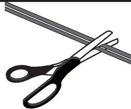
1. Couper la longueur désirée du fil compatible TR64 pour faire la connexion de fil à l'intérieur du système de connexion KLIPR. **L'ensemble contient deux connecteurs mâles aux deux extrémités du câble CC; assurez-vous de conserver un connecteur si vous envisagez d'installer l'assemblage via un hub de connexion rapide.**
