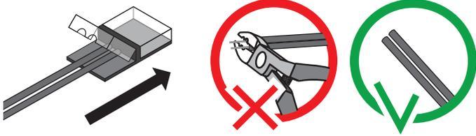
4. Pousser sur le couvercle en plastique pour le fermer, veillez à ne pas fermer accidentellement le couvercle de l'autre côté. Utilisez des pinces pour fermer complètement le connecteur jusqu'à ce que vous entendiez un clic indiquant que la connexion est bonne. Les clips du couvercle sont des deux côtés du connecteur KLIPR.
