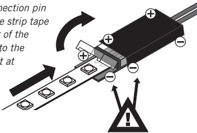
8. Pousser sur le couvercle en plastique pour le fermer. Utilisez des pinces pour fermer complètement le connecteur jusqu'à ce que vous entendiez un clic indiquant que la connexion est bonne. Les clips du couvercle sont des deux côtés du connecteur KLIPR.
