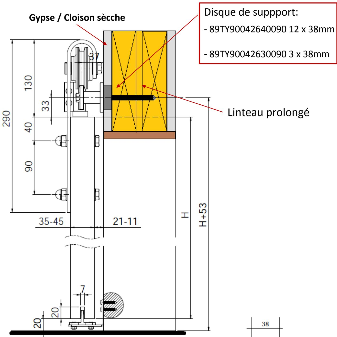
Percer un trou de 38 mm (1-1/2 po) dans la cloison sèche ou le panneau de gypse et insérer le(s) disque(s) à l'épaisseur de cloison sèche appropriée.
