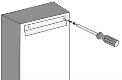
**Step 1.** Attach mounting bracket to back of item to be hung using provided 5/8" self-drilling screws. **Étape 1.** À l'aide des vis autotaraudeuses de 5/8 po, attacher le support de montage à l'endos de l'objet à suspendre.
