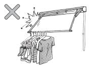
Ne pas suspendre des vêtements de 8 kg ou plus (après le cycle d'essorage). (Cela peut causer des dommages.)
