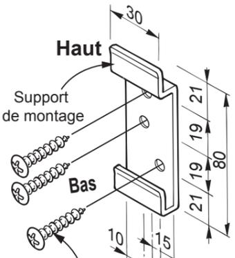
Vis de fixation pour support de montage (à tête bombée large 4 x 30; 3 vis/supports)
