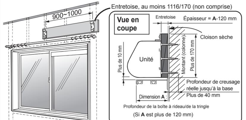
\* Percer un trou avec des vis (minimum de 3 par entretoise) qui dépasseront d'au moins 40 mm de la base, puis les fixer. Ne pas utiliser les débris de panneau de particules.
