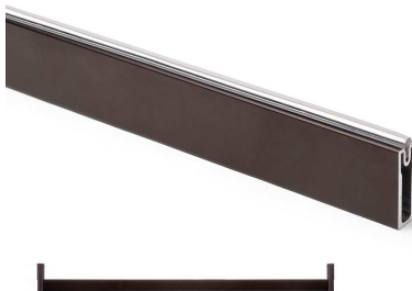
#1310312060: Tringle à recouper Montage sous étagère (2x2323121060) ou sur les côtés de caisson (2 x2323120060) Longueur: 3000mm (118") Largeur: 12mm (1/2") Hauteur: 33mm (1 3/8") À utiliser avec 2 supports latéraux et 1 support central
