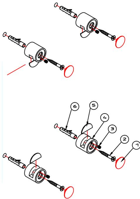
Diamètre du trou dans le substrat; 5mm
