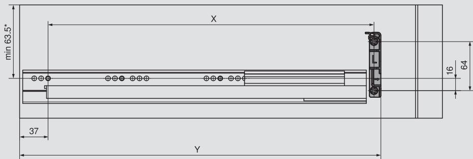
X Drilling position | Positions de perçage
