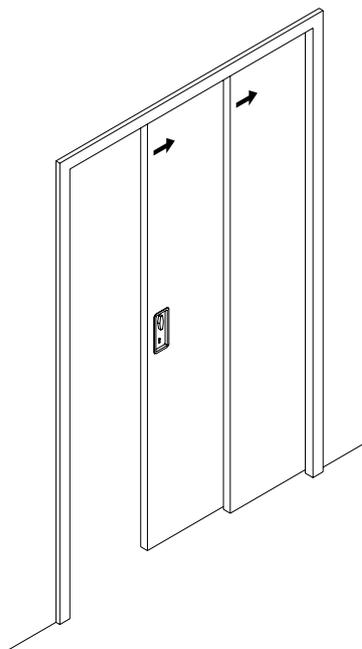
**Ferrure pour le coulissement simultané de 4 portes pesant jusqu'à 40 kg ou de 2-3 portes pesant jusqu'à 80 kg par vantail.**
