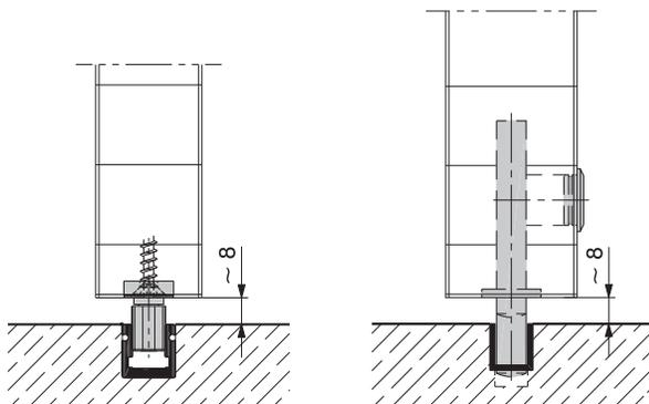
Guides inférieurs pour rail de guidage de 10 mm de largeur intérieure
