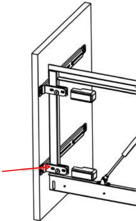
Vis d'ajustement d'angle d'ouverture de porte.
