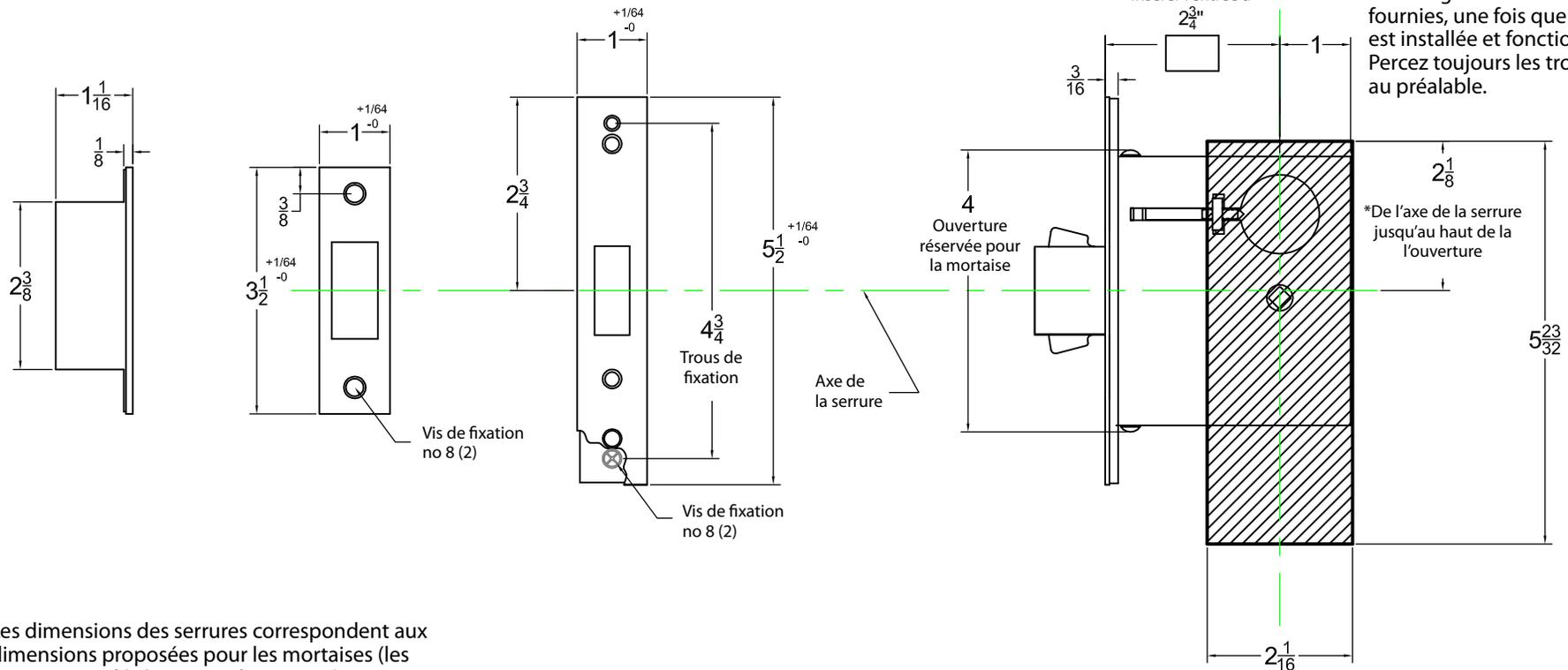
\* Fixez la garniture avec les vis fournies, une fois que la serrure est installée et fonctionnelle. Percez toujours les trous de vis au préalable.
