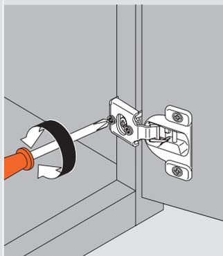
Les COMPACT 38N, 39C et 38C ont un réglage de la profondeur par came.
